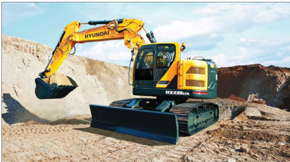
Koparki Hyundai Serii HX wyposażone w dwuczęściowy wysięgnik zapewniają operatorom większe możliwości działania. Mogą one kopać głębiej i wykorzystując większy zasięg precyzyjniej manipulować osprzętem roboczym
